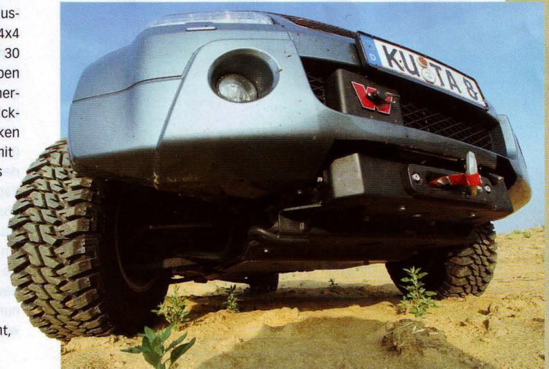
**Seilwinde** perfekt eingepasst – raubt zwar 7,5° Böschungswinkel, schützt aber den Motor.
