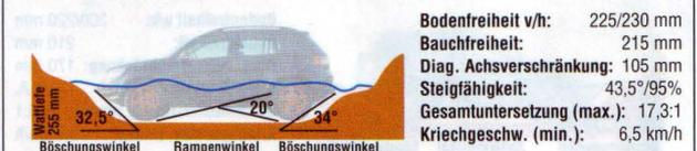
**ROAD FAZIT:** Durch den clever nachbearbeiteten Heckabschluss gewinnt der Tiguan hinten 9° Böschungswinkel (Serie 25°). Doch der tiefhängende mittige Unterfahrschutz hält die Bauchfreiheit unverändert. Der VW krabbelt besser als der Freelander: min.: 6,5 km/h!
