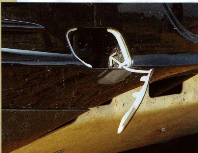
**Einschraubösen** sind eines Offroaders unwürdig. Beim Testwagen fehlten sie: Bergen unmöglich.
