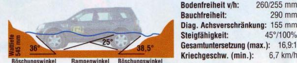
**ROADFAZIT:** 290 mm Bauchfreiheit sind ein Wert wie bei den Großen und die Goodyear MT-Reifen in Range Rover-Größe liefern Traktion im Überfluss. Leider hält die Kupplung mit dem, was Freigangswinkel, Antrieb und Pneu's bieten, nicht Schritt.
