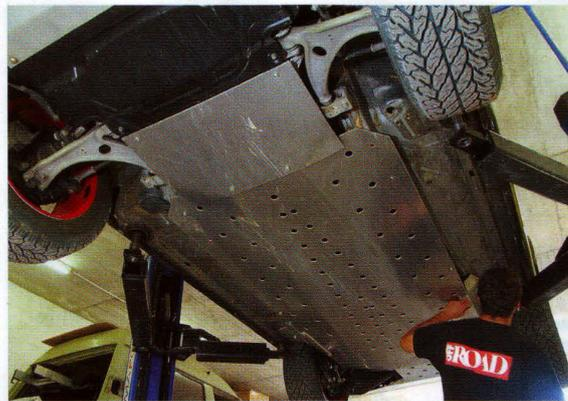
**Tiguan:** Front- und Heckunterfahrerschutz genügen höchsten Ansprüchen, durch den hinteren gewinnt man sogar drei bis vier Grad Böschungswinkel. In einem Offroader untragbar: Reifen-Klebespray und Mini-Kompressor. Das 215 Euro teure Aufpreis-Notrad wäre auch kein Segen.
