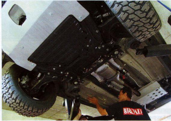
**Freelander:** Die Matzker-Unterfahrerschutzbleche sind unglaublich gut eingepasst und vergeuden keinen Zentimeter Bodenfreiheit. Dazu sind sie extrem stabil – wir konnten keines verbiegen. Ein schmäleres Rad im Range Rover-Durchmesser würde in die Mulde passen!
